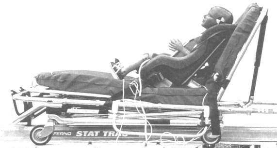
**Figura 5** - Sistema de retenção conversível fixo na maca
