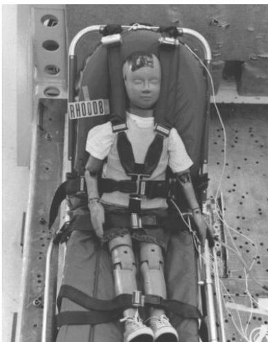
**Figura 7** - Sistema de arnês de 5 pontos de fixação na maca
